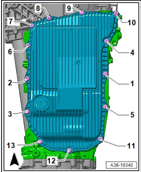
– Schrauben in 2 Stufen in der gezeigten Reihenfolge festziehen:
