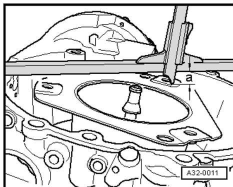
Wenn der Wandler richtig eingesetzt ist, muss der Abstand -a- zwischen der Fläche der Befestigungsaugen und der Fläche der Wandlerglocke folgenden Wert betragen:
