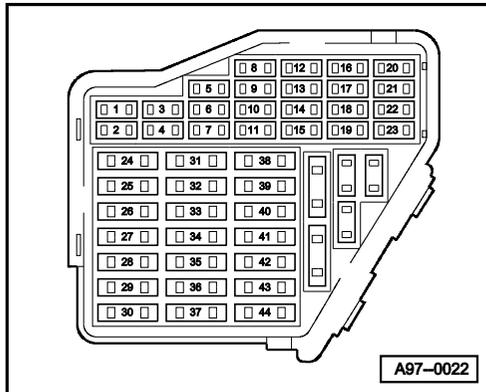
Sicherungen im Sicherungshalter werden ab Sicherungsplatz 23 im Stromlaufplan mit 223 bezeichnet.
