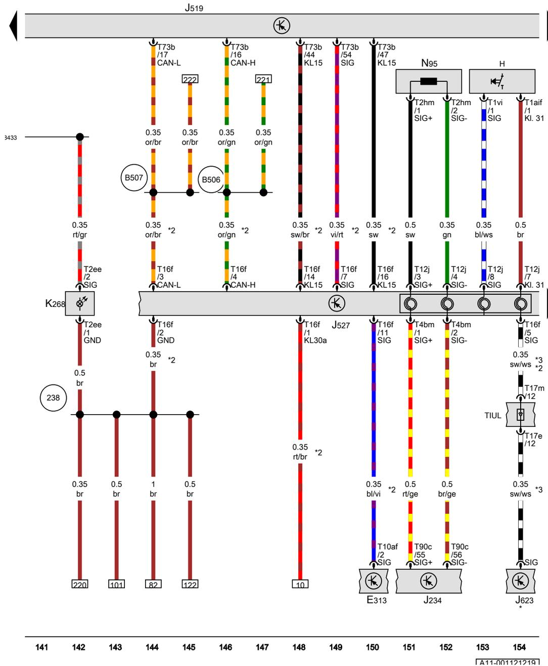
Signalhornbetätigung, Bordnetzsteuergerät, Steuergerät für Lenksäulenelektronik, Fußraumleuchte vorn links, Zünder für Airbag Fahrerseite
