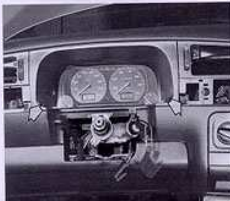
Die Blende um das Kombi-Instrument wird von zwei Kreuzschlitzschrauben (Pfeile) gehalten.
